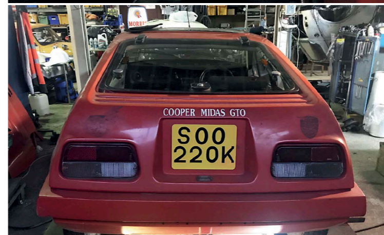
Pakoputki ikävästi vedetty keskelle vaikka sille olisi syvennyt oikeassa reunassa. Takavalot ja bensakorkki kummassakin Midaksessa samat kuin Triumphin TR7:ssa
