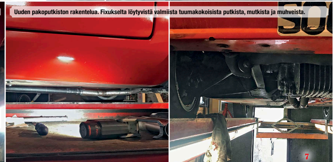
Pakoputki ikävästi vedetty keskelle vaikka sille olisi syvennyt oikeassa reunassa. Takavalot ja bensakorkki kummassakin Midaksessa samat kuin Triumphin TR7:ssa
