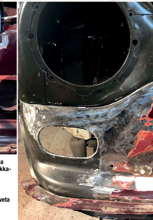
Etupää maalattuna epoxilla. Hyvältä näyttää ja kun tulee vähänkin valmista on mukavampi siirtyä seuraavaan kohteeseen
