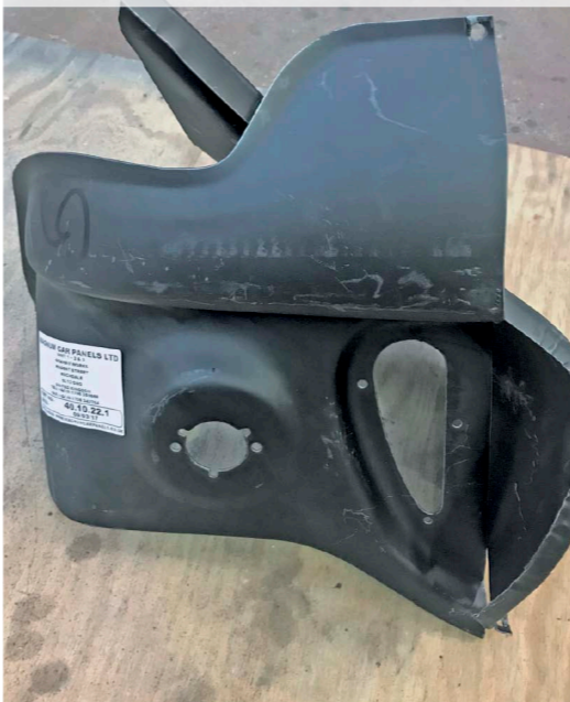
Yllä normaali Minin etukulman korjauspala jo leikeltynä tulevaan muotoonsa ja alla Rileyyn mätä kulma. Vilkunreiät ovat siis aivan erilaiset.
