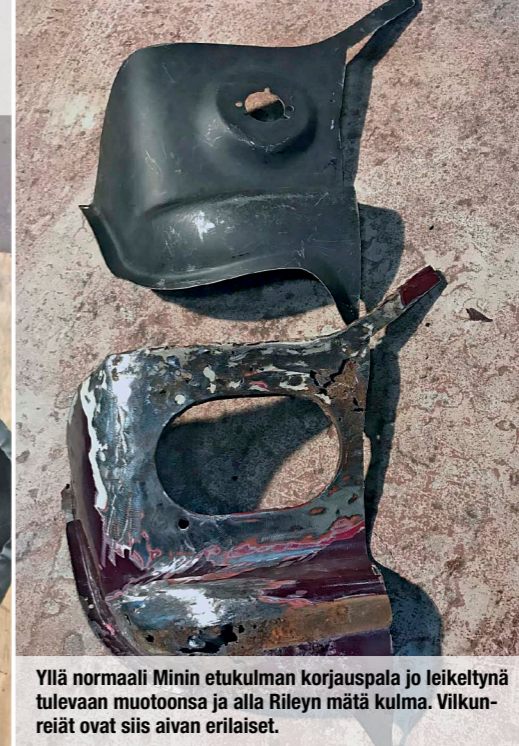
Minin maski kun on leveämpi niin Minin kulmapala ei riitä korvaamaan aivan kaikkea ruostetta, joutuu pellinpalan siihen lisäksi. Koko yläreunan kumminkin saa.
