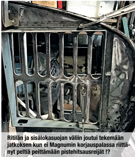
Poratut pistehitsaukset sisälokasuojan toiselta puolelta. Teinpä samalla tuohon sisälokasuojan alaosaan samanlaisen huoltoreijän kuin on toisellakin puolella!
