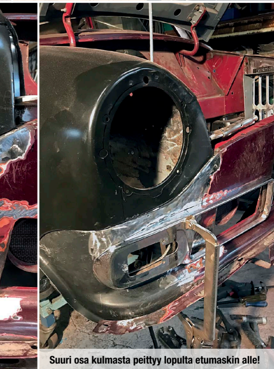
Etupää maalattuna epoxilla. Hyvältä näyttää ja kun tulee vähänkin valmista on mukavampi siirtyä seuraavaan kohteeseen
