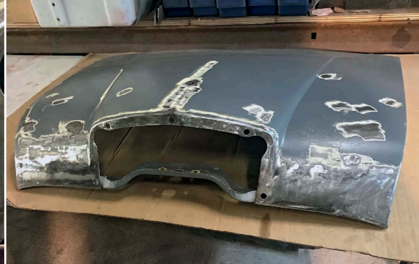
Uutta peltiä jo paikallaan mutta tämä konepelti osoittautuikin erilaiseksi eikä sitten sopinutkaan konepellin reikään yhtä hyvin kuin alkuperäinen?!!
