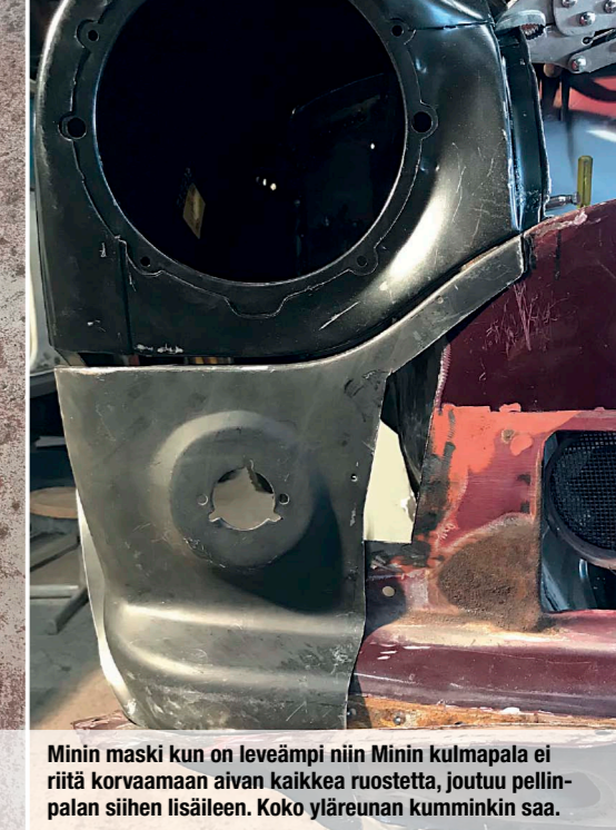
Yllä normaali Minin etukulman korjauspala jo leikeltynä tulevaan muotoonsa ja alla Rileyyn mätä kulma. Vilkunreiät ovat siis aivan erilaiset.
