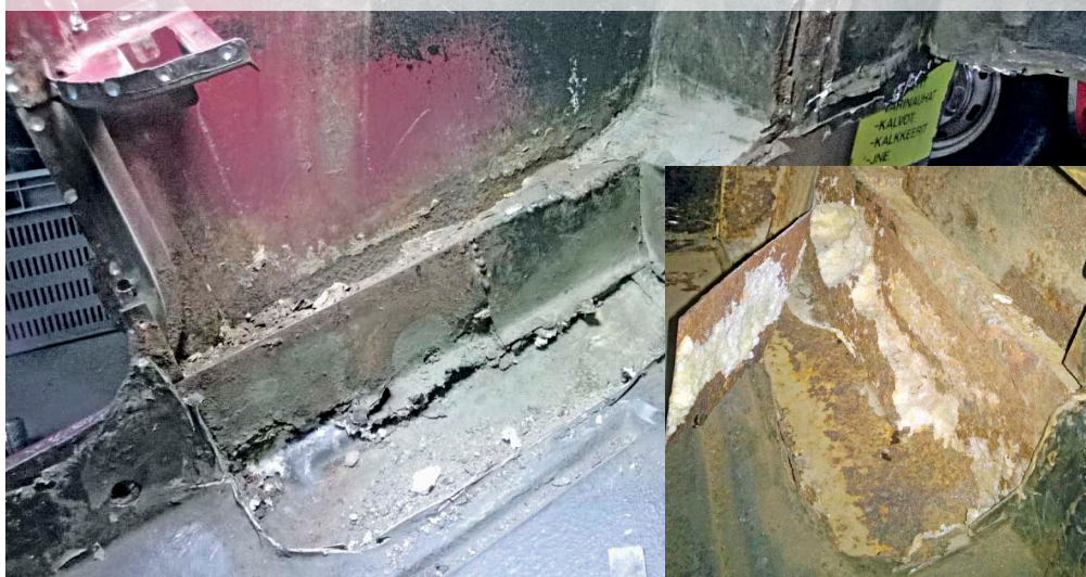
Näin "saarelaisammattilaiset" korjas Minin lattioita!? Uus vaan vanhan päälle!
