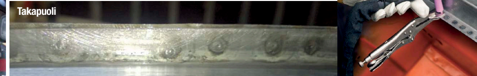
Pistehitsauskoneet kun on niin äärettömän kömpelöitä, niin Tigilläkin saa tehtyä näin siistiä jälkeä. Ainoa vaatimus on että pellit on saatava puristettua hyvin toisiinsa kiinni, muuten toinen pelti vain sulaa. Tuollaisen sarjan "Eastwood TIG Spot Welding Kit for TIG Welder" ostin saarelta osoitteesta www.frost.co.uk maksaa vähän yli 40€. Tollaset pihdithän voi tehdä tietty itsekin, mutta suuttimet tuppaa aina tuohon muotoon räjäköitäessä murtumaan!
