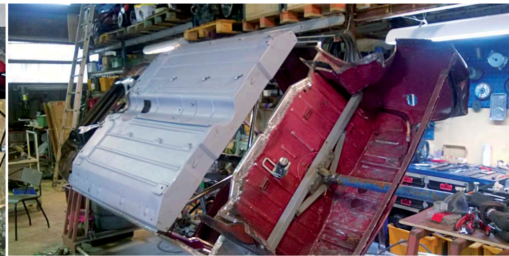
Takalattia on välillä pitänyt poistaa. Tehdä lopulliset sovitukset ja hitsata nyt lopullisesti paikoilleen takakelkan paikoilleen saamiseksi. Selkänojan alaosankin oli ruoste kadottanut ja oli rakennettava uudelleen.
