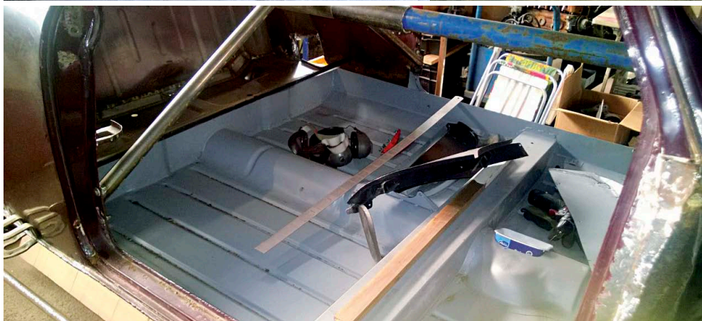
Uusi lattia saapunut ja sovitushomma alkanut vanhoilla kynnyksillä, parempi sovitella lattiaa ennenkö nekin poistaa, muuten ei pysy koko auto enään kasassa ja vääntyiis turhaan!?
