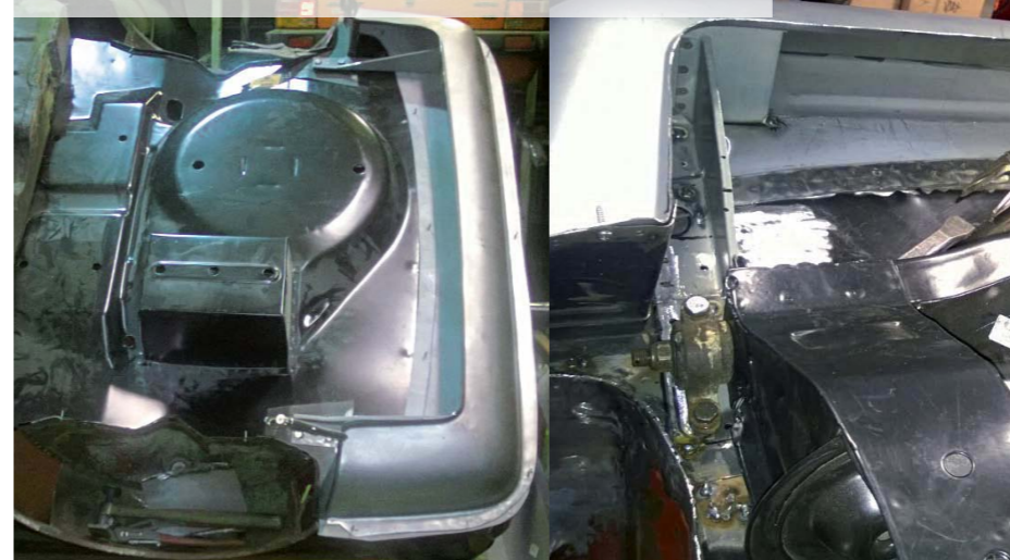
Sovittelu- ja asennusvaiheessa uusi takalattia ja takahelma.
