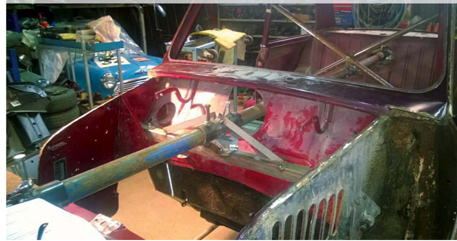
Tuo auton läpi kulkeva putki olisi vain saanut olla paksumpaa, taipuu nyt hieman.
