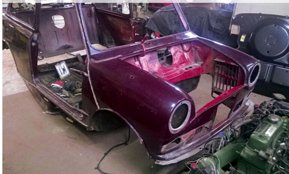
Alkuun syksyllä 2013 auto seisoj vain kuormaustilavilla. Tässä jo kaikki irtoava ruuvattuna pois. Vanha takalattia poistettuna ja uusi takalattia näkyvissä jo kuvassa.
