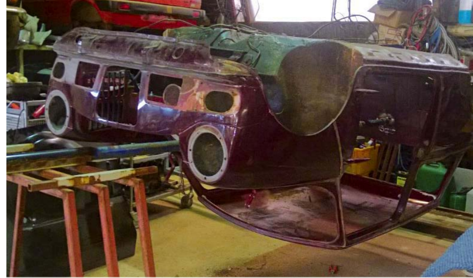
Grillissä autoa voikin nyt sitte pyöritellä haluamaansa asentoon ja homma helpottuu huomattavasti.
